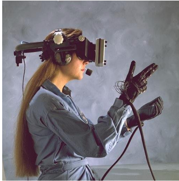
Gambar 27 Headmounted display (interactive imaging system) seperti ini (berkembang pesat di dunia games ) akan membantu para arsitek untuk ‘berada’ ( immerse ) dalam lingkungan yang didesainnya dan mengeksplorasi banyak hal sebelum benar-benar dibangun. Selain visual dan audio, tidak tertutup kemungkinan suhu dan bau dapat disimulasikan juga (wikipedia; 10/09/09).
