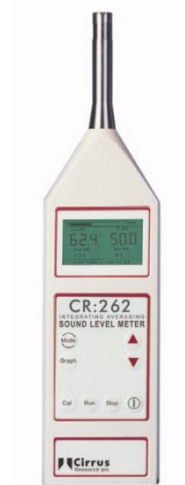
Gambar 83 Sound level meter dapat membantu kita merasakan secara fisik setiap tingkatan bunyi sesuai ukuran dB (deciBel). Versi yang lebih canggih dapat dihubungkan ke komputer sehingga data dapat dianalisis secara real-time .
