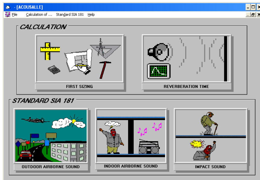
Gambar 114 Software Acousalle dapat digunakan dalam awal desain untuk memerkirakan sound proofing dan sound absorbing yang diperlukan. Software ini tidak dapat menangani bentuk geometris yang rumit dan menurut pembuatnya tidak kompatibel dengan Windows XP/Vista (penulis mencoba dengan Windows XP dapat bekerja dengan baik). 39
