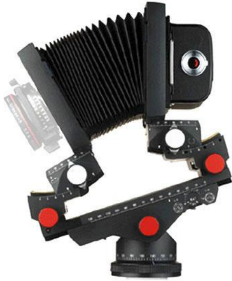
Gambar 109 Lensa untuk mengoreksi perspektif vertikal yang bermanfaat untuk memotret obyek-obyek arsitektural yang tinggi. 38
