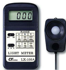
Gambar 84 Lux meter dapat membantu kita merasakan secara fisik gelap dan terang cahaya dan ukurannya menurut lux.
