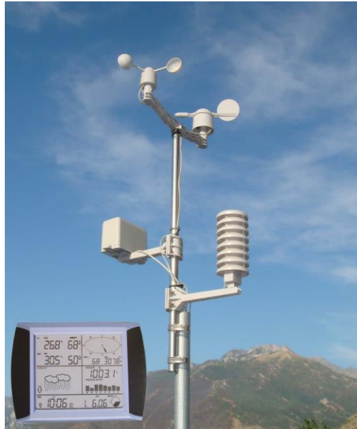
Gambar 75 Pencatat cuaca digital dapat disambungkan ke laptop atau komputer untuk melihat cuaca secara real-time dalam setahun atau lebih dan menyimpannya sebagai pembentuk data iklim. Bagi arsitek yang menekuni iklim, dapat memakai satu komputer sederhana yang bertugas menyimpan data secara real-time dalam jangka lama (bahkan mungkin lebih dari setahun). (proweatherstation.com; 23/09/09)
