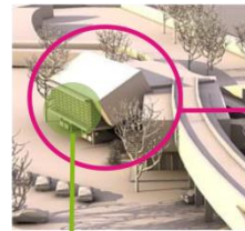
Penggunaan second skin berupa rambatan tanaman, dengan rangka aluminium pada ruang-ruang yang menghadap ke barat. Peletakan ruang pada posisi seperti ini dilakukan pada ruang-ruang yang tidak menutup adanya kedetuhan ekstra (seperti foyer, dan koridor)
